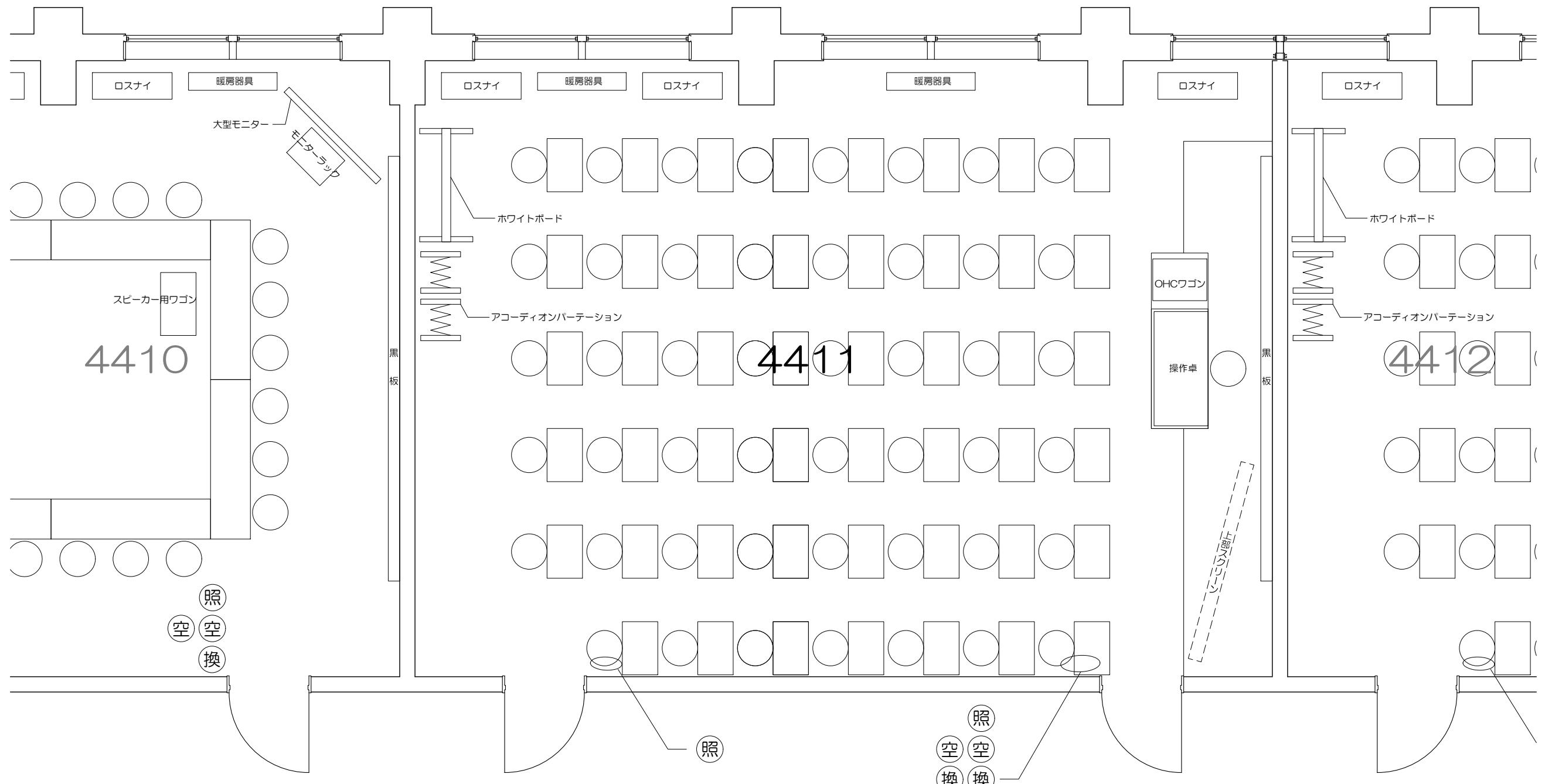
凡例 (照) : 照明スイッチ (空) : 空調スイッチ (換) : 換気スイッチ
