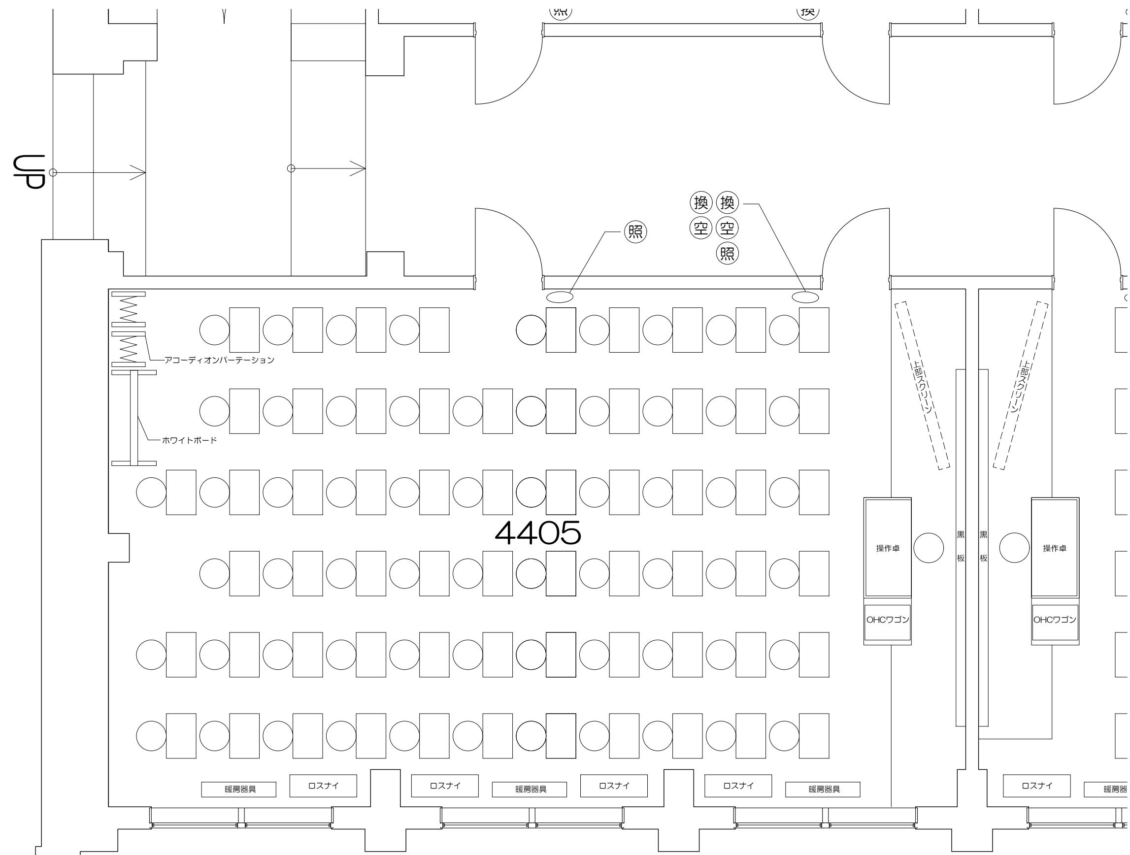
凡例 (照) : 照明スイッチ (空) : 空調スイッチ (換) : 換気スイッチ
