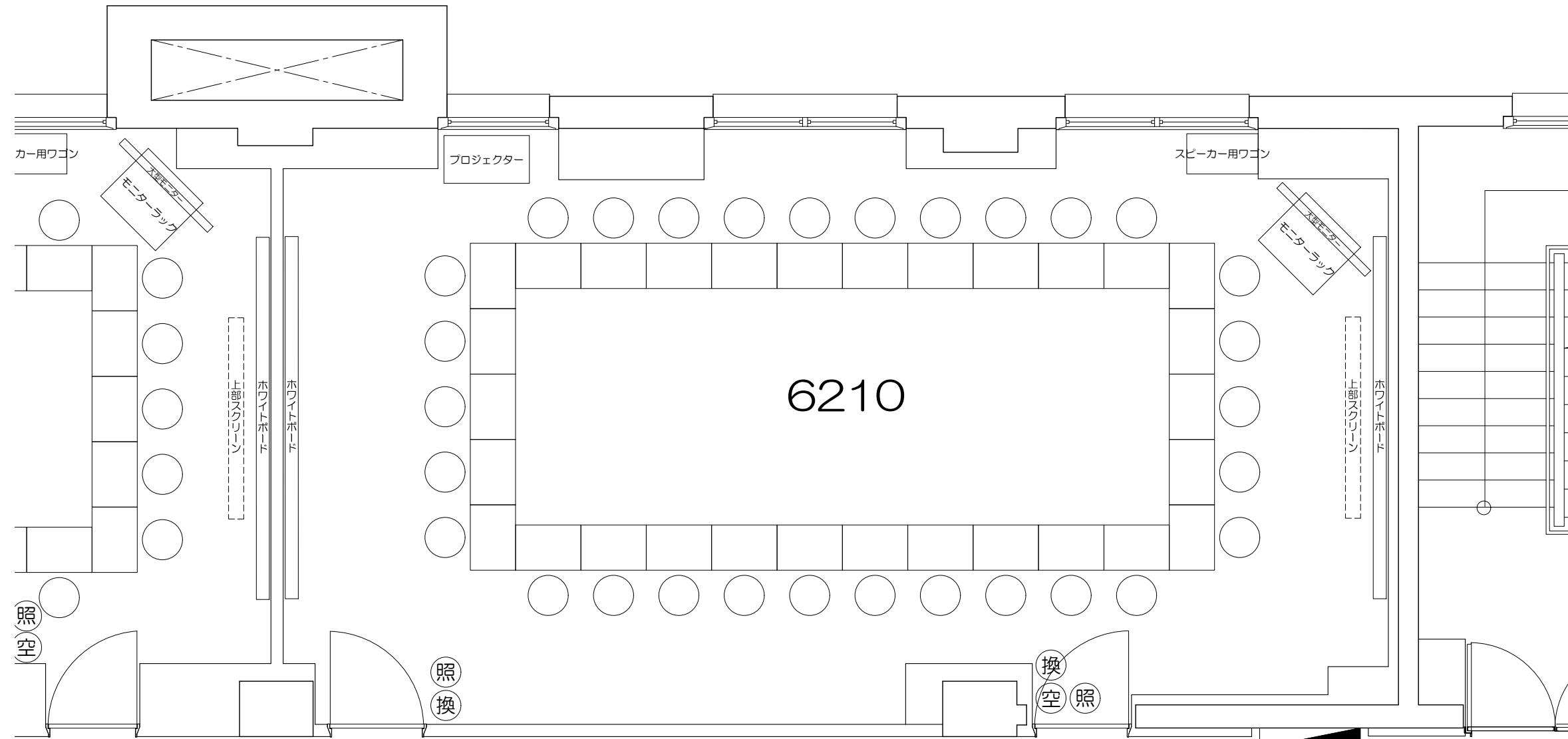
凡例 (照) : 照明スイッチ (空) : 空調スイッチ (換) : 換気スイッチ
