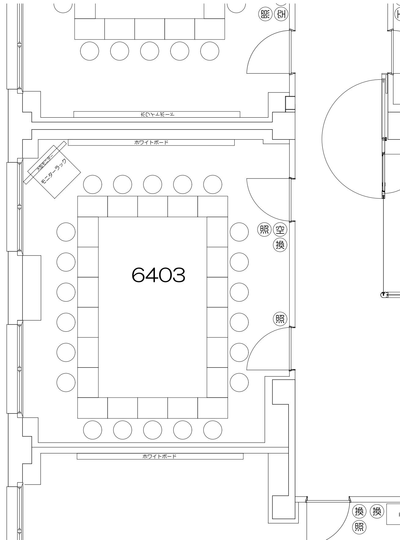
凡例 (照) : 照明スイッチ (空) : 空調スイッチ (換) : 換気スイッチ
