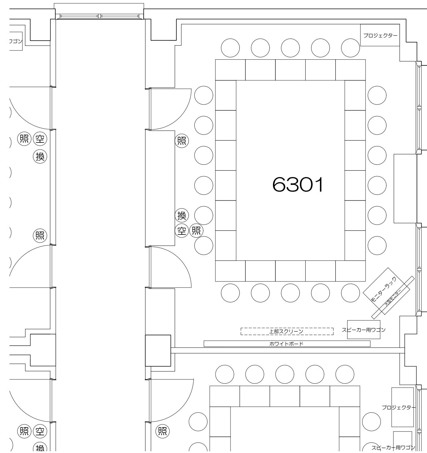
凡例 (照) : 照明スイッチ (空) : 空調スイッチ (換) : 換気スイッチ
