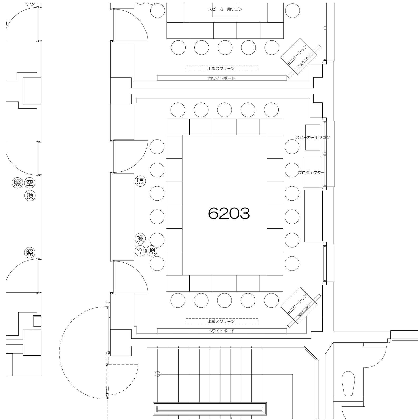
凡例 (照) : 照明スイッチ (空) : 空調スイッチ (換) : 換気スイッチ
