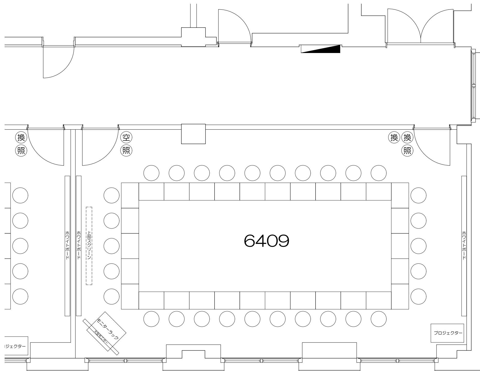
凡例 (照) : 照明スイッチ (空) : 空調スイッチ (換) : 換気スイッチ
